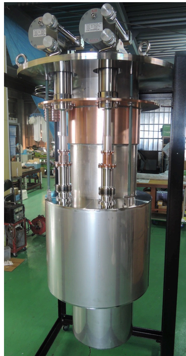
クライオスタット内部冷凍機
