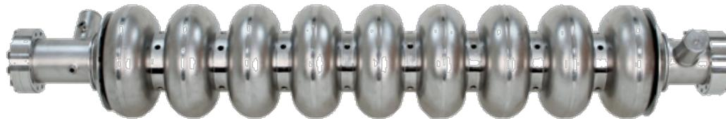
従来の加速空洞では加速勾配  $40\sim 50$  MV/mが限界
