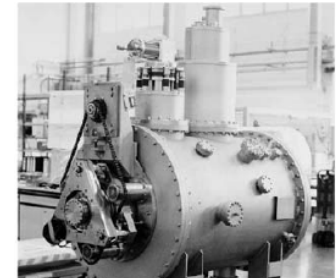
JAERI-FEL (4K モジュールの例) 高圧ガスの規制を受けない装置
